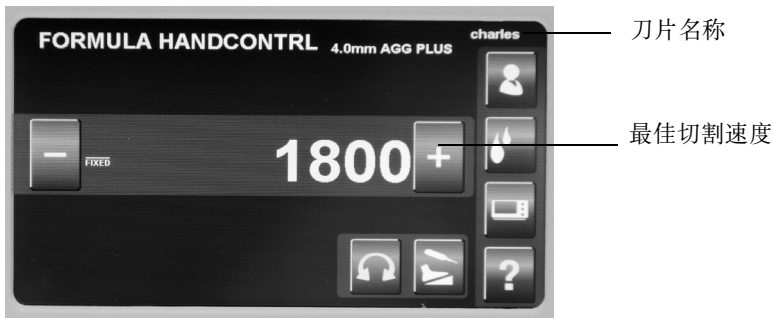
图 8： 将 4.0 毫米 Aggressive Plus 刀片插入 Formula 手持机后，CORE 控制台屏幕上显示的信息
