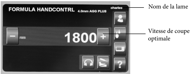
Figure 8 : Écran de la console CORE après insertion d'une lame Aggressive Plus de 4 mm dans la pièce à main Formula
