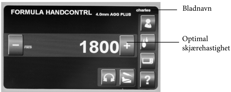
Figur 8: CORE-konsollskjermen, etter at et 4,0 mm Aggressive Plus-blad er satt inn i Formula-håndstykket
