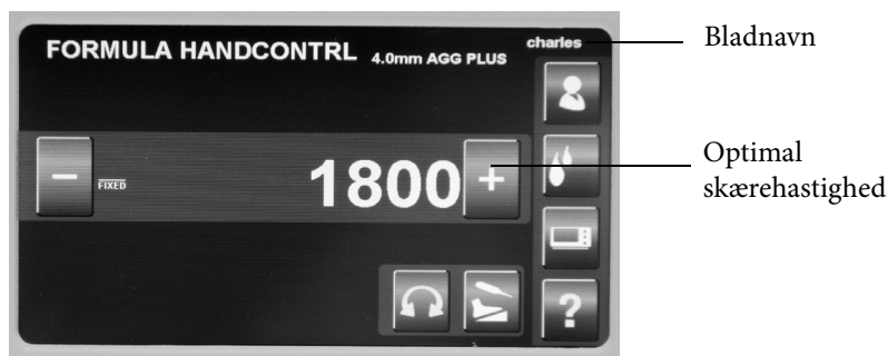
Figur 8: CORE-konsolskærmen efter at et 4,0 mm Aggressive Plus-blad er indsat i Formula håndstykket
