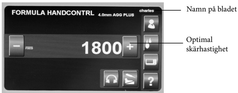
Figur 8: CORE-konsolens skärm efter det att ett 4,0 mm blad av typen Aggressive Plus har satts in i Formula handstycke
