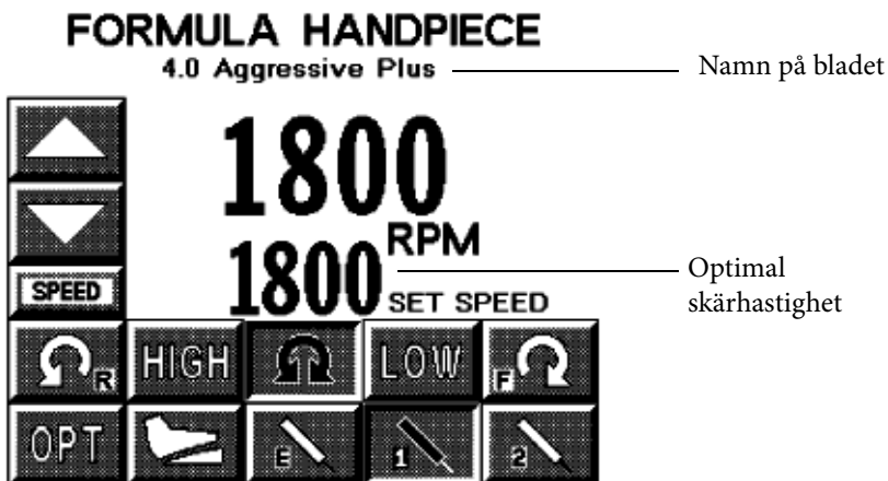
Figur 7: TPS-konsolens skärm efter det att ett 4,0-mm blad av typen Aggressive Plus har satts in i Formula handstycke
