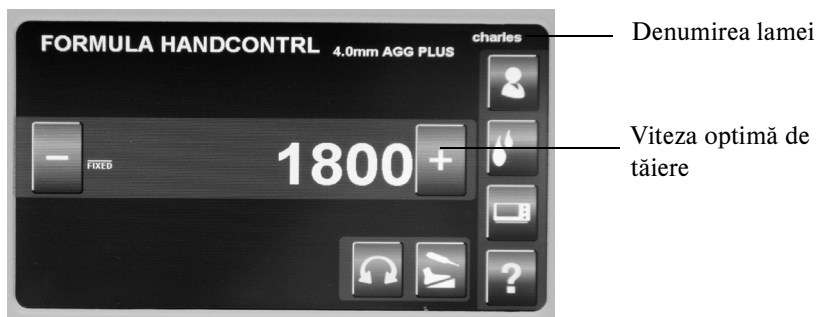
Figura 8: Ecranul Consolei CORE după introducerea în Mănerul de aplicare Formula a unei lame Aggressive Plus de 4,0 mm
