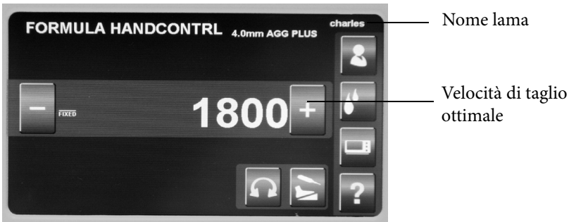
Figura 8: Schermo della consolle CORE dopo l'inserimento di una lama Aggressive Plus da 4 mm nel manipolo Formula
